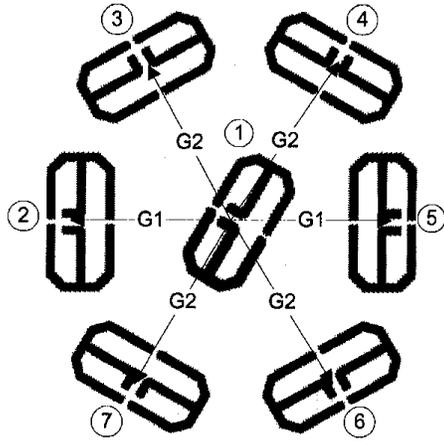
Fig. 8: Antenna array radiation layer. Central element's dimensions as in Figure 1,  $a=8.5\text{mm}$ ,  $b=18.5\text{mm}$ ,  $d=0.8\text{mm}$ ,  $W1=5.6\text{mm}$ ,  $W2=2.5\text{mm}$ ,  $L1=7.7\text{mm}$ ,  $L2=3\text{mm}$ ,  $S1=1.1\text{mm}$ ,  $S2=1.6$ . Spacing  $G1=20\text{mm}$ ,  $G2=25\text{mm}$ .
